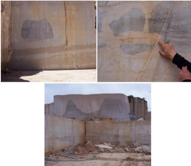
Figura 29. Aspectos particulares de ocorrência das manchas de cor cinzenta azulada. Repare-se que as manchas correspondem a zonas centrais de blocos limitados por descontinuidades a partir das quais ocorre alteração supergênica.
