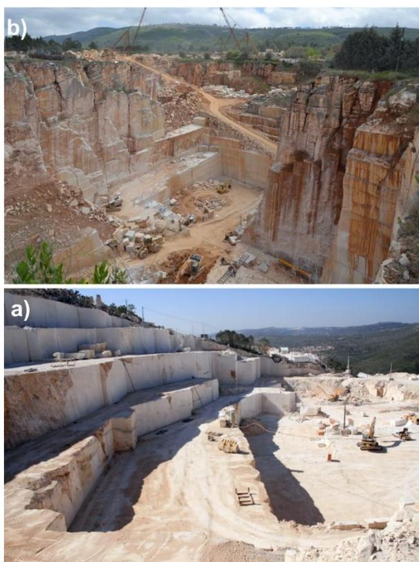
Figura 5. Tipos de lavra nas pedreiras do MCE. a) pedreira no flanco ocidental do Cabeço Gordo no núcleo do Codaçal; b) pedreira em poço no núcleo de Moleanos.
