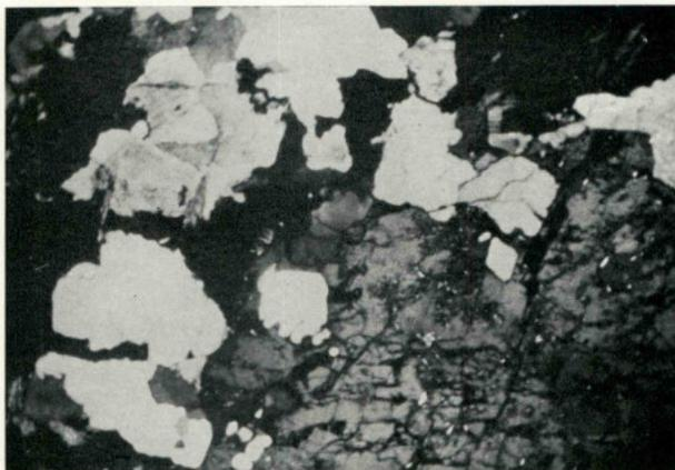
Foto 8 — Granito alcalino. Couto (1 500 m a S de S. Silvestre). Grande feldspato potássico assaz corroído pelo quartzo e incluindo este mineral, por vezes em «gotas» com contornos amibóides. Nícois +; 32 $\times$ .
