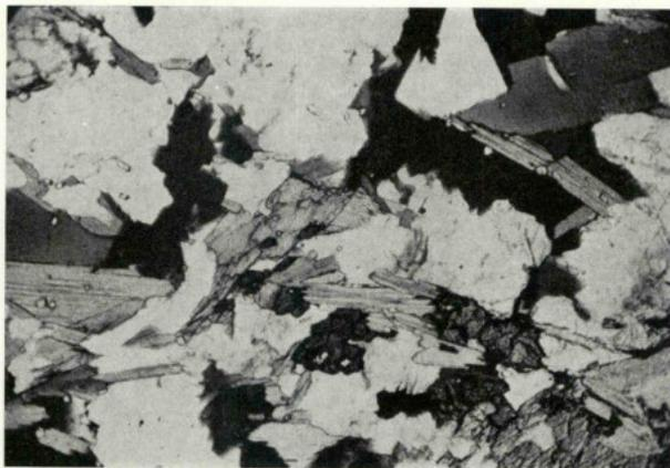
Foto 15 — 50 m E do cemitério de Candemil. Rocha do tipo granodiorítico, com variados mafitos: biotite, clorite, hornblenda, esfena, magnetite. Sem analisador; 32 $\times$ .
