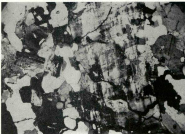
Foto 13—Granito alcalino com duas micas. 500 m E de Lanhas (Maciço do Monte de Góis). Microclina-perthite e quartzo, por vezes goticular, incluso nos feldspatos. Nicóis +; 32 $\times$ .
