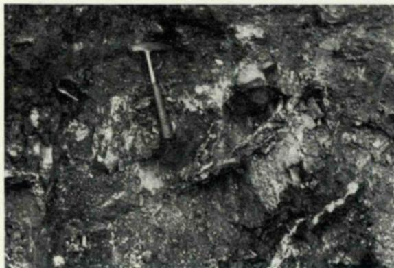
Fot. 5—Pequena escavação, nos serpentinitos, destinada à extracção do asbesto, em que são visíveis alguns dos seus veios.
