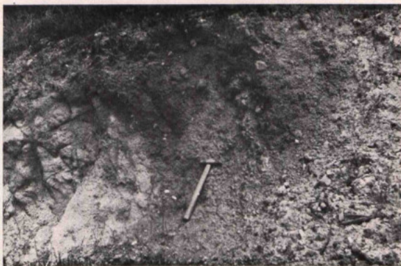
Fig. 2 — Falha entre as areias pliocénicas (à esquerda) e os xistos (à direita). Ao centro, rocha triturada. Estrada para a Zambujeira.
