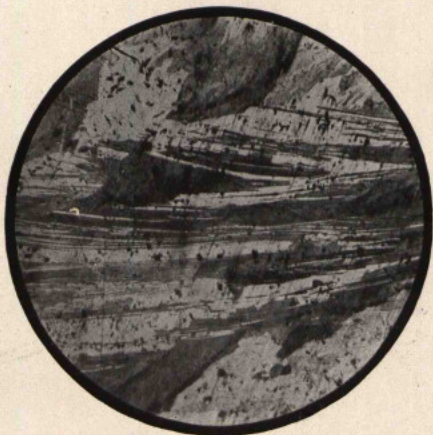
FIG. 42 ( \times 70 ) Minas do Braçal. — Vurtzite; ataque pelo H I.
