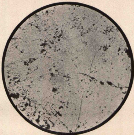
FIG. 59 ( \times 67 ) Mina de S. Domingos. — Pirite, sem ataque
