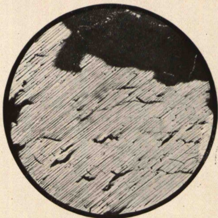
FIG. 35 ( \times 67 ) Mina do Bogalho. — Calcosite sem ataque
