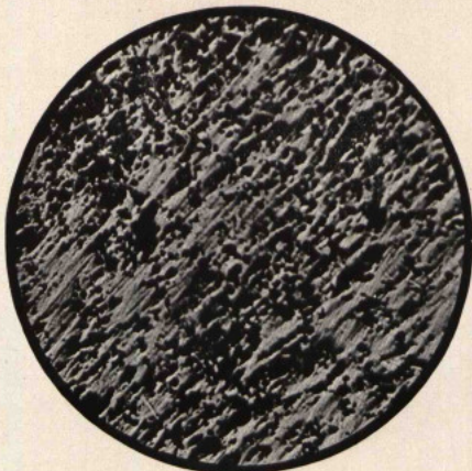
FIG. 41 ( \times 67 ) Minas do Braçal. — Vurtzite; sem ataque
